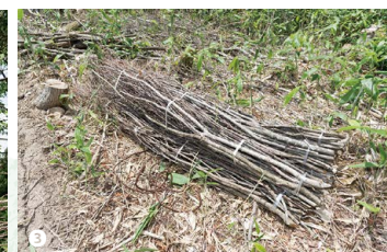
①粗朶沈床は明治初期にオランダから日本に伝えられた。「柵掻き（しがらぎ）」と呼ばれる組み立て作業はすべて手作業で行われる ②結束台で長さをそろえた粗朶を結束することを「粗朶束（まるけ）」という ③葉が落ちてから芽吹く前に木を切ると品質が向上し、良くなる粗朶ができる
